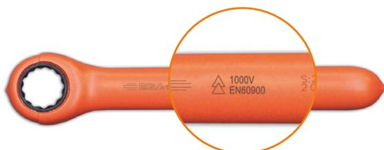
Las herramientas aisladas pueden ser identificadas gracias al marcaje sobre el material aislante. El símbolo que debe incluir es un doble triángulo seguido del marcaje de 1000V y una referencia a la normativa. Adicionalmente, las herramientas EGA Master siempre incluyen la referencia del producto y el año de fabricación para una mejor trazabilidad.
